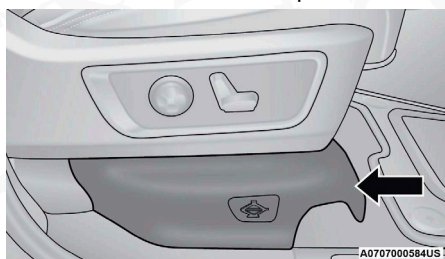
Cubierta de acceso al gato
