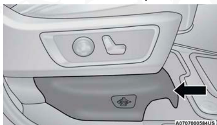
Cubierta de acceso al gato
