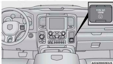
Toma de inversor de energía
