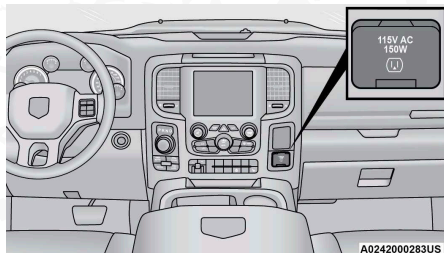
Toma de inversor de energía
