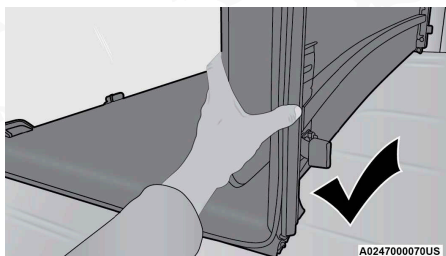
Doblado correcto - Mantenga paneles juntos
