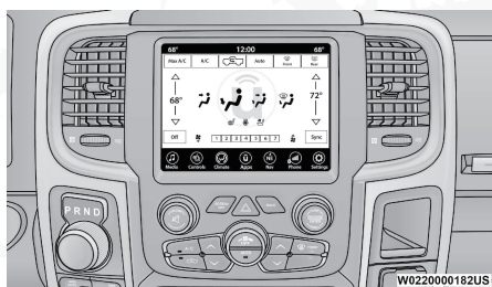
Control de clima automático en Uconnect 5 con pantalla de 8.4”
