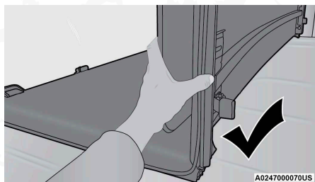
Doblado correcto - Mantenga paneles juntos
