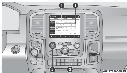
Botones en tablero y pantalla de 8.4" con Uconnect 5
