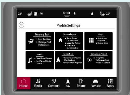
Ajustes guardados a través de perfiles en Uconnect 5 / 5 NAV con pantalla de 8.4”
