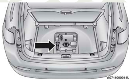
Ubicación del embudo de llenado de emergencia
