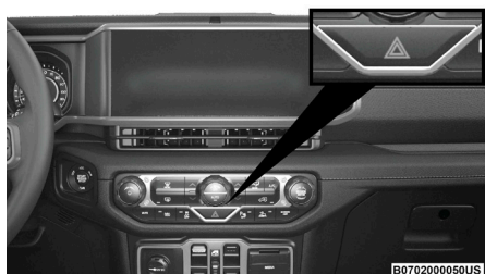
Interruptor de las luces de emergencia
