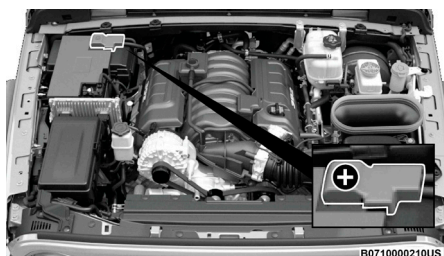
Poste positivo (+) de la batería — Motor 6.4L
