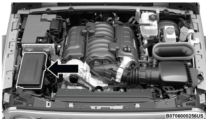
Ubicación del centro de distribución de potencia (6.4 Litros)
