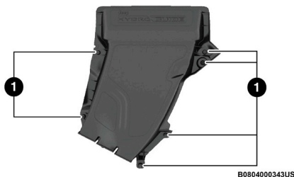
Cámara de separación de agua
