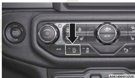
Interruptor de apagado del sistema de Paro/Arranque
