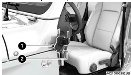
Colocación del soporte del espejo en el vehículo
