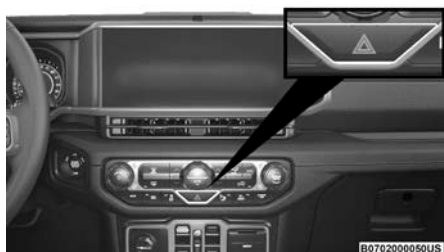
Interruptor de las luces de emergencia
