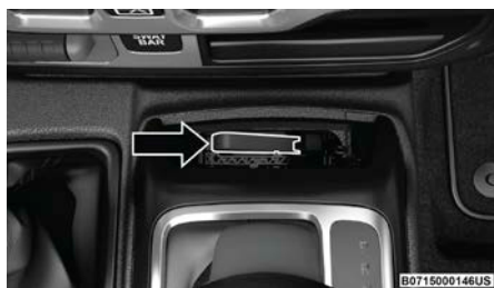
Reinstalando la correa
