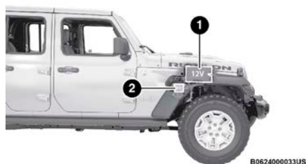
Ubicación de las baterías
