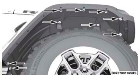
Cubierta interna de los arcos de la llanta
