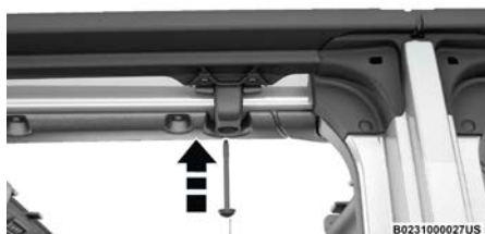
Colocación de los tornillos por debajo del marco
