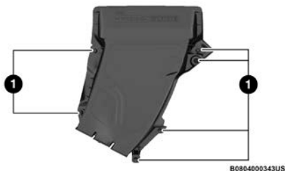
Cámara de separación de agua
