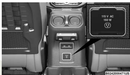
Inversor de corriente
