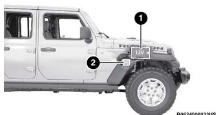
Ubicación de las baterías
