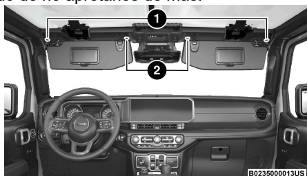
Ubicación de los tornillos Torx al interior
