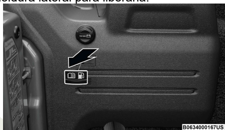
Liberación de emergencia de la compuerta de combustible
