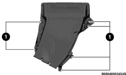
Cámara de separación de agua
