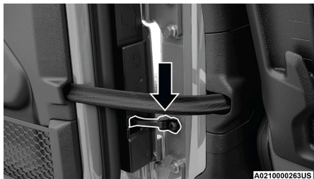
Retenedor de la puerta (enganchado)
