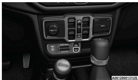
Interruptor de la barra estabilizadora
