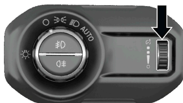
Control de atenuación
