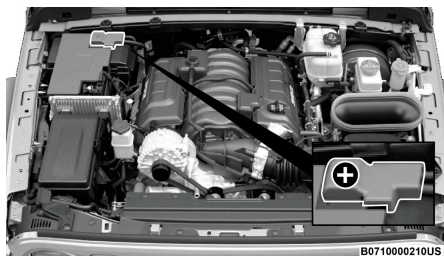
Poste positivo (+) de la batería — Motor 6.4L
