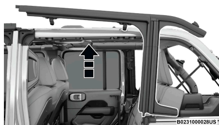
Removiendo el marco hacia arriba
