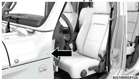
Ubicación del perno de la cubierta
