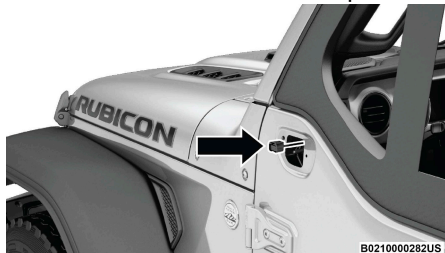
Ubicación del Arnés de Cableado
