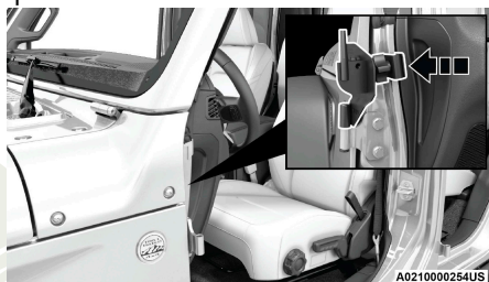
Empuje el soporte en el pilar A
