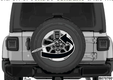
Desbloqueo de la cubierta de la cámara trasera
