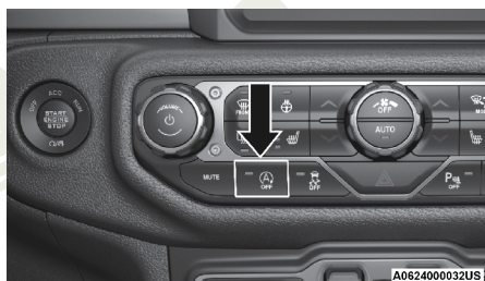
Interruptor de apagado del sistema de Paro/Arranque
