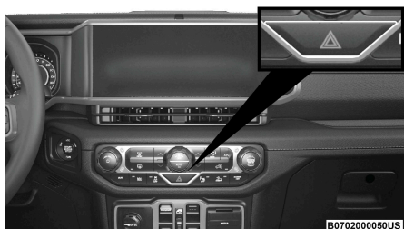
Interruptor de las luces de emergencia
