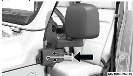
Ubicación de los tornillos del espejo
