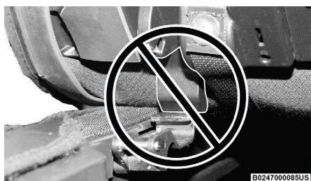
Fijador asentado incorrectamente
