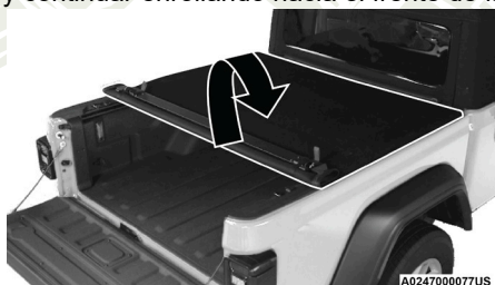
Enrollado de la cubierta hacia el frente
