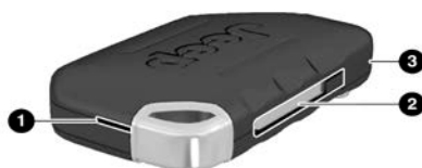
1-3 — Puntos para hacer palanca en la cubierta trasera
