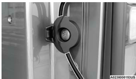
Cable de la compuerta trasera correctamente asentado
