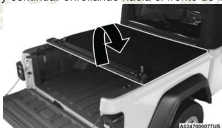
Enrollado de la cubierta hacia el frente
