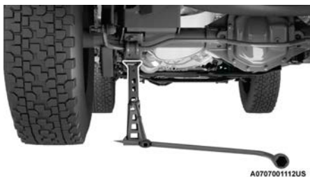
Colocación del gato en la parte trasera
