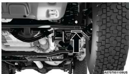
Punto de levantamiento en la parte delantera
