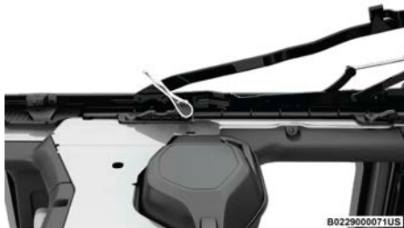
Desatornillar los sujetadores del mecanismo
