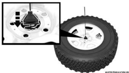
Reinstalando el retenedor
