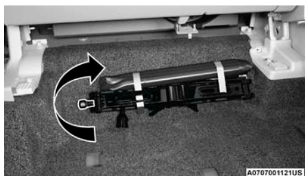
Tornillo de fijación del gato
