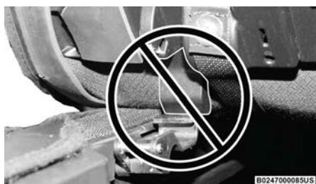
Fijador asentado incorrectamente
