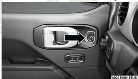
Ajuste de espejos eléctricos
