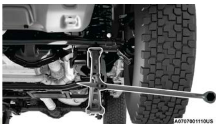
Colocación del gato en la parte delantera
