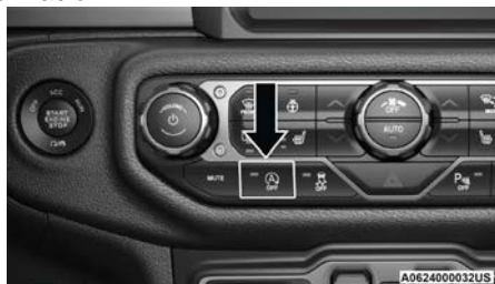
Interruptor de apagado del sistema
