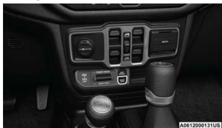
Interruptor de la barra estabilizadora
