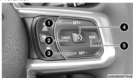
Botones del control electrónico de velocidad
