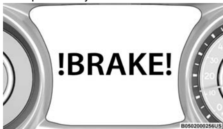
Mensaje de asistencia de frenado de emergencia (PEB)
