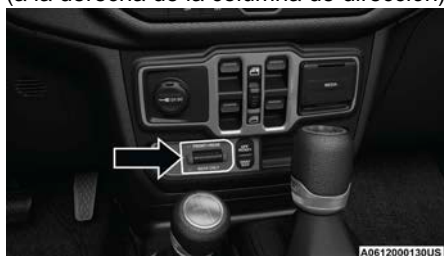
Interruptor de bloqueo del eje
