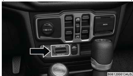
Interruptor de bloqueo del eje
