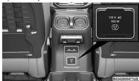
Inversor de corriente
