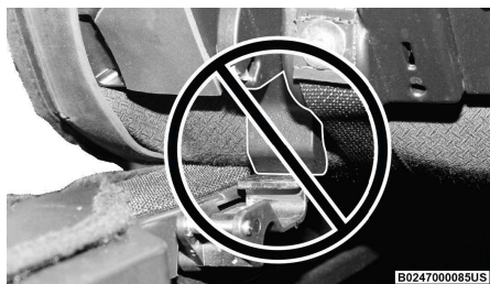
Fijador asentado incorrectamente
