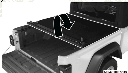
Enrollado de la cubierta hacia el frente
