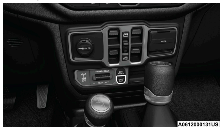
Interruptor de la barra estabilizadora
