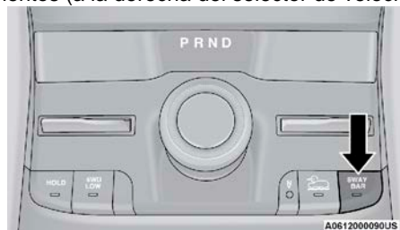
Interruptor de la barra estabilizadora
