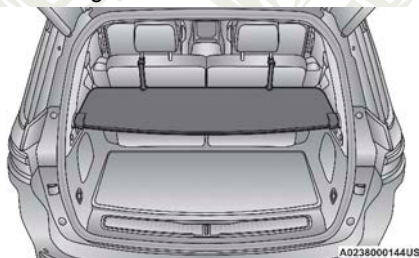
Cubierta del área de carga
