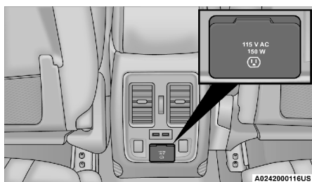
Inversor de corriente
