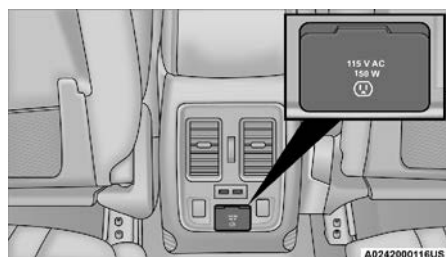
Inversor de corriente
