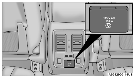
Inversor de corriente
