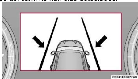
Sistema encendido (líneas grises)
