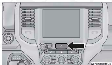
Interruptor de las luces de emergencia
