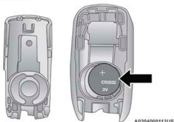
Ubicación de la batería del control
