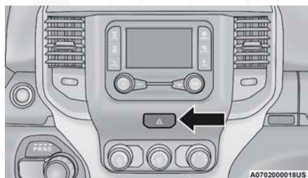
Interruptor de las luces de emergencia
