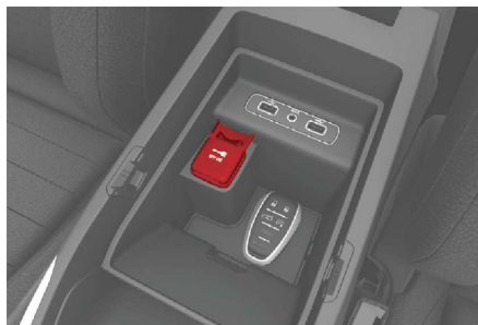
Inversor de corriente
