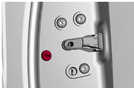
Cilindro de bloqueo de liberación manual de cerradura de puerta
