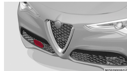
Ubicación del radar en la defensa delantera
