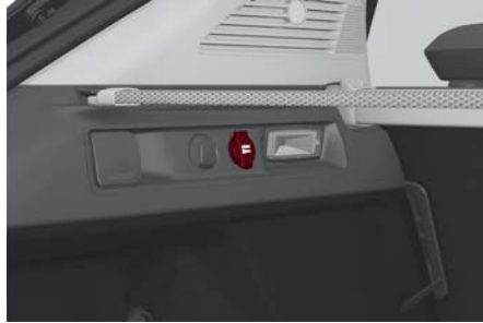
Toma de corriente del área de carga
