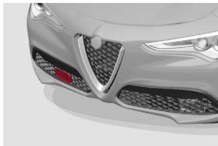
Ubicación del radar en la defensa delantera
