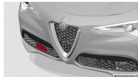
Ubicación del radar en la defensa delantera
