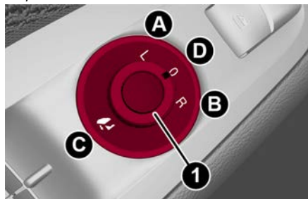
Control eléctrico del espejo
