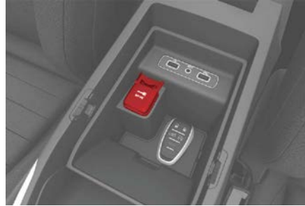
Inversor de corriente
