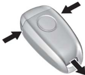
Retiro de la cubierta del transmisor
