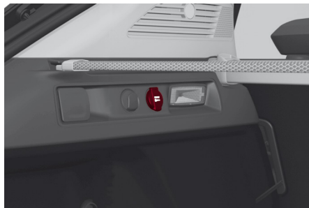
Toma de corriente del área de carga
