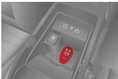
Ubicación para la colocación del transmisor
