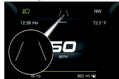
Líneas de carril no detectadas
