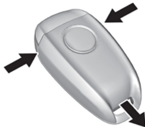
Retiro de la cubierta del transmisor
