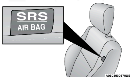
Etiqueta de la bolsa lateral (SAB) instalada en el asiento
