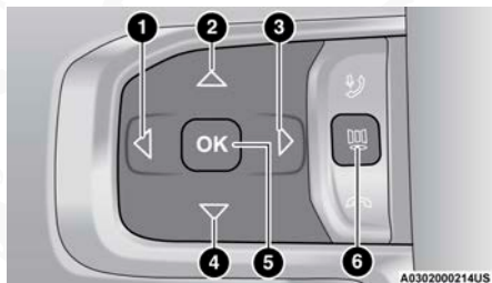
Botones de control de la pantalla del módulo de instrumentos tipo 3
