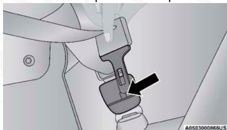
Desprendimiento de la hebillita con la lengua del cinturón de seguridad
