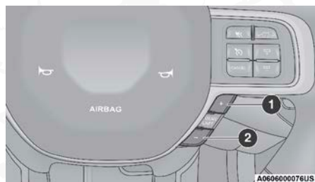
Selector de cambios de columna
