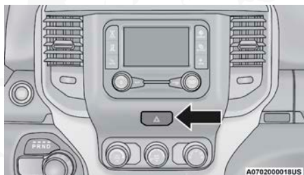
Interruptor de las luces de emergencia
