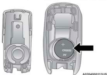
Ubicación de la batería del control
