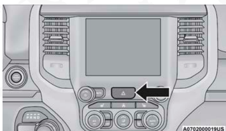
Interruptor de las luces de emergencia
