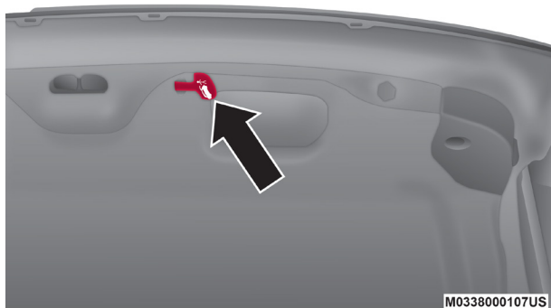
Liberador interno de emergencia de la cajuela
