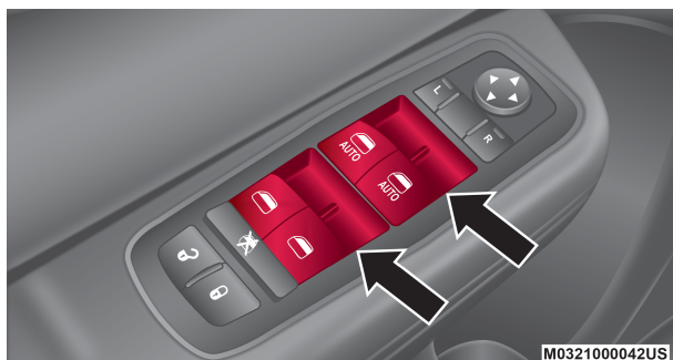
Interruptores de las ventanas eléctricas
