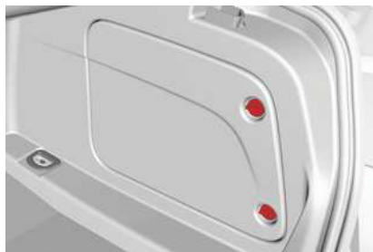
Panel de acceso a la Batería
