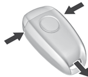
Retiro de la cubierta del transmisor
