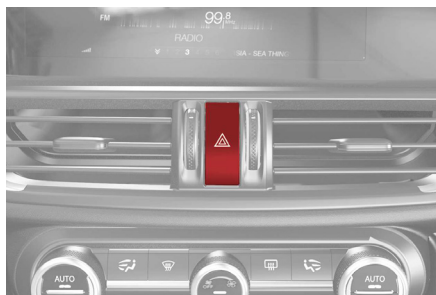
Interruptor de las luces de emergencia
