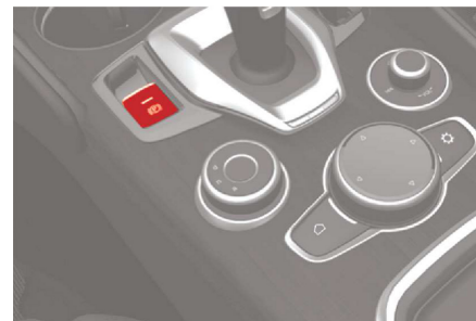
Interruptor del freno de estacionamiento eléctrico
