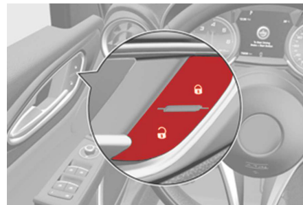
Interruptores de bloqueo y desbloqueo de puertas
