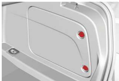
Panel de acceso a la Batería
