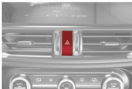
Interruptor de las luces de emergencia
