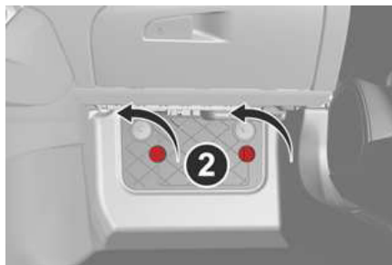
Enganches de fijación en el descansapies
