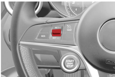
Interruptor SET del control de velocidad electrónico
