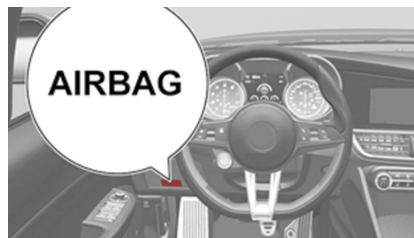
Bolsa de aire para rodillas del conductor
