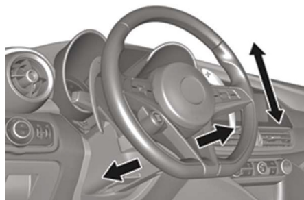
Ajuste del volante de la dirección
