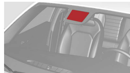
Ubicación de la cámara del parabrisas
