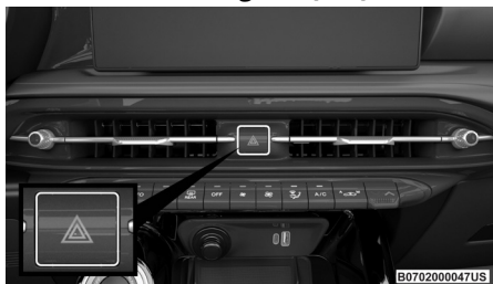
Interruptor de las luces de emergencia
