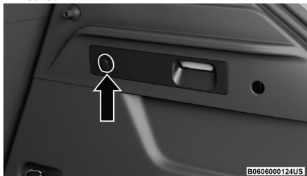
Ubicación del liberador de la compuerta.
