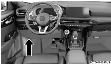
Ubicación de los fusibles interiores
