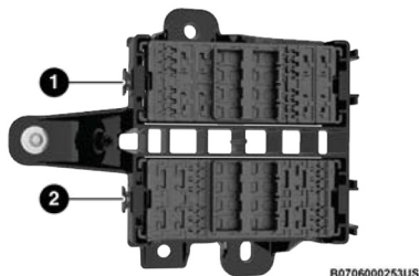
Ejemplo de unidades de fusibles traseras
