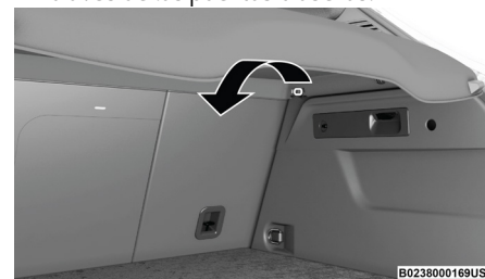
Retiro del poste de la cubierta
