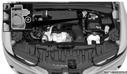
Poste positivo (+) de la batería — Motor 2.0L
