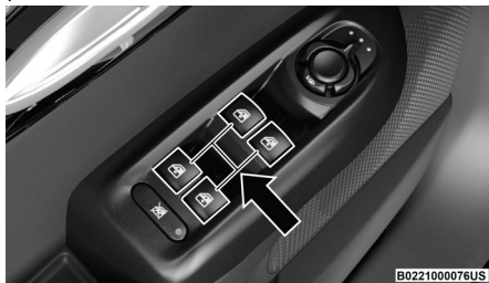
Interruptores de las ventanas
