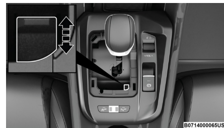
Ubicación del liberador del selector de velocidades
