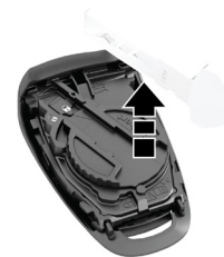
Extracción de la llave de emergencia
