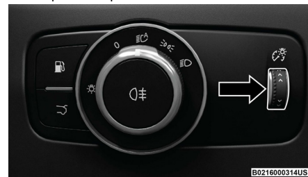
Control de atenuación
