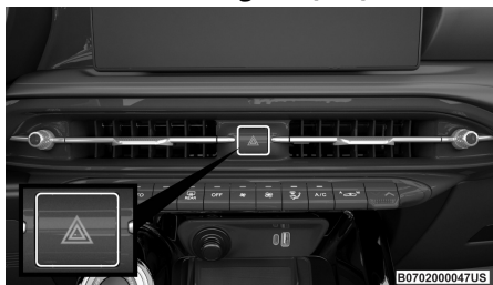
Interruptor de las luces de emergencia
