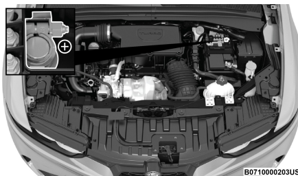
Poste positivo (+) de la batería — Motor 2.0L
