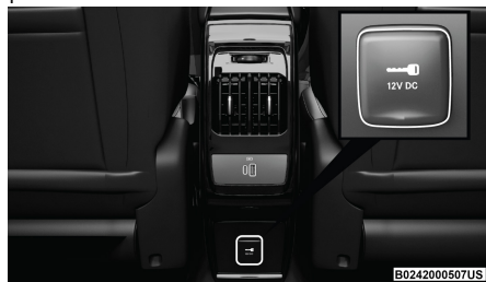
Toma de corriente detrás de la consola central (si así está equipado)
