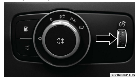
Control de atenuación
