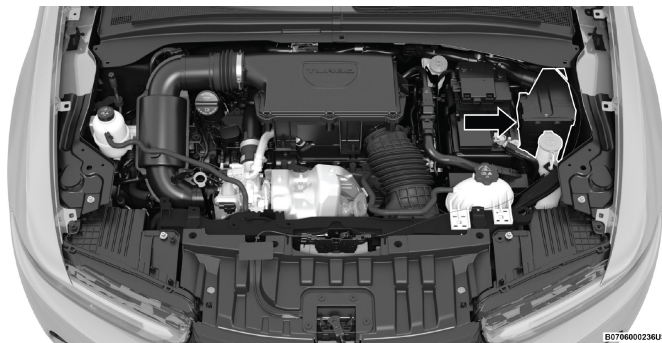
Ubicación del centro de distribución de energía — Motor 2.0L
