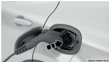
Inserte el conector de carga dentro del puerto de carga del vehículo
