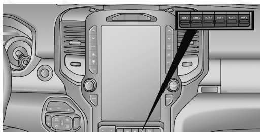
Ubicación de los interruptores auxiliares
