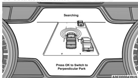
**Presione OK para cambiar al sistema de asistencia para estacionarse perpendicularmente**
