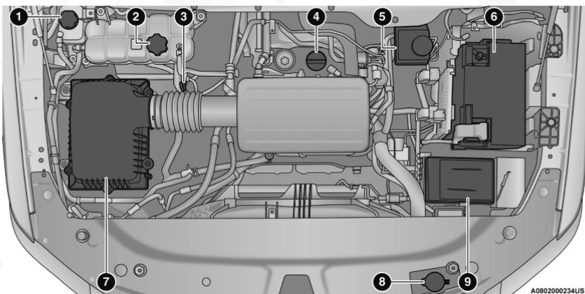
1. Tapón de presión del depósito de refrigerante de la unidad del motor generador
