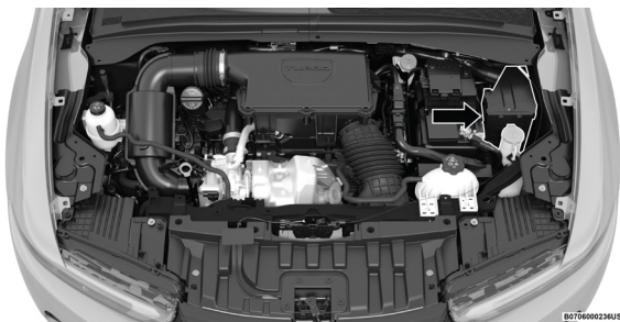
Ubicación del centro de distribución de energía
