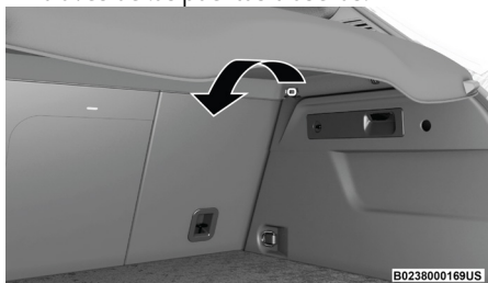
Retiro del poste de la cubierta
