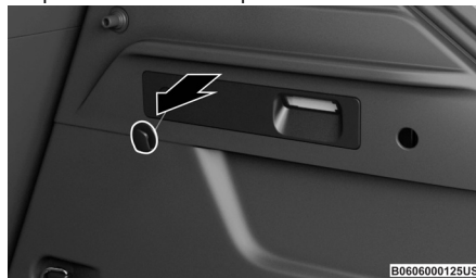
Liberación de emergencia de la compuerta
