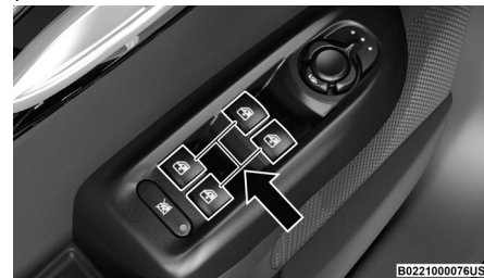
Interruptores de las ventanas
