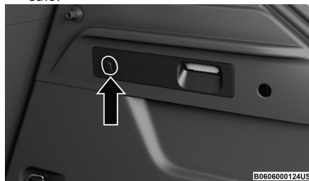
Ubicación del liberador de la compuerta.
