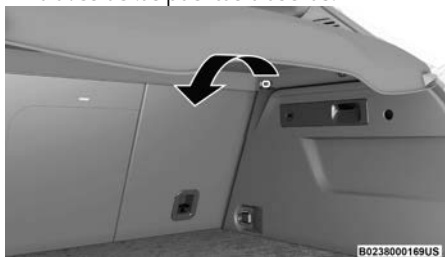
Retiro del poste de la cubierta
