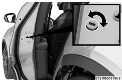
Bloqueo de emergencia
