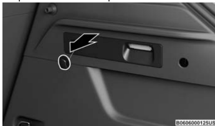
Liberación de emergencia de la compuerta
