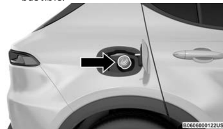
Tubo de llenado de combustible
