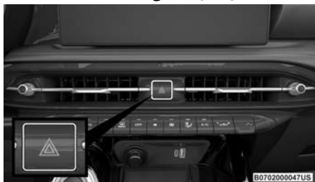
Interruptor de las luces de emergencia
