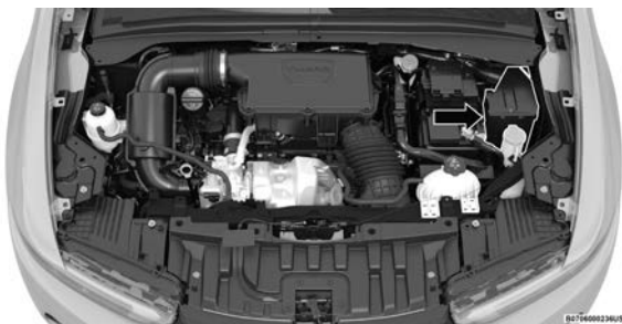
Ubicación del centro de distribución de energía
