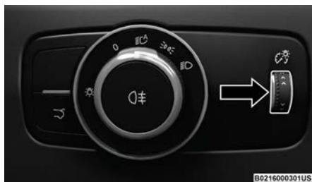
Control de atenuación
