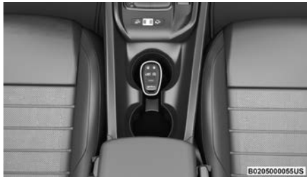
Ubicación para la colocación del transmisor
