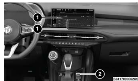
Botones en pantalla y tablero del sistema Uconnect® 5/5 NAV con pantalla de 10.25"
