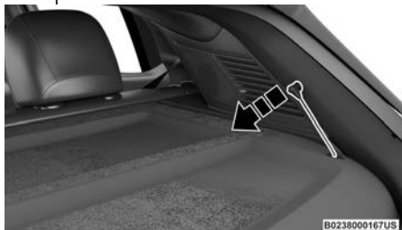
Desconexión de los postes de la cubierta
