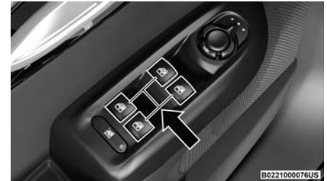
Interruptores de las ventanas
