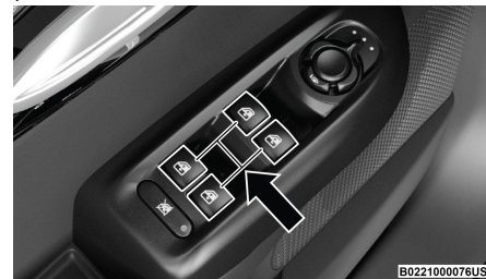
Interruptores de las ventanas
