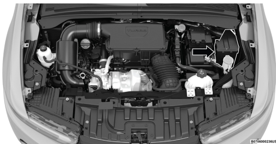
Ubicación del centro de distribución de energía
