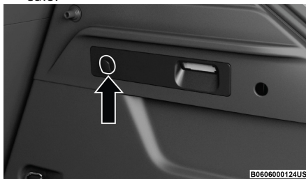
Ubicación del liberador de la compuerta.
