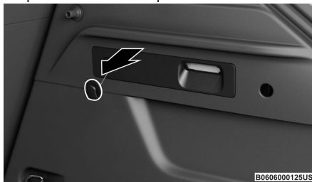
Liberación de emergencia de la compuerta
