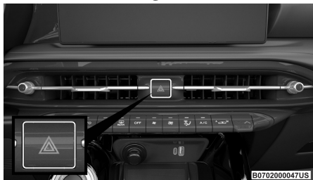
Interruptor de las luces de emergencia
