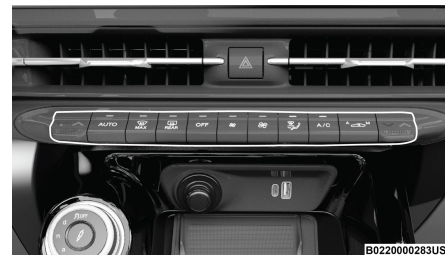
Conjunto de interruptores en el panel de instrumentos del control automático de clima
