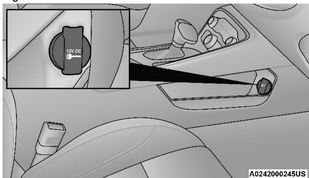
Toma de corriente del puerto del centro integrado
