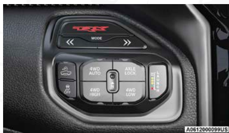
Cuatro Posiciones/Caja de transferencia bajo demanda
