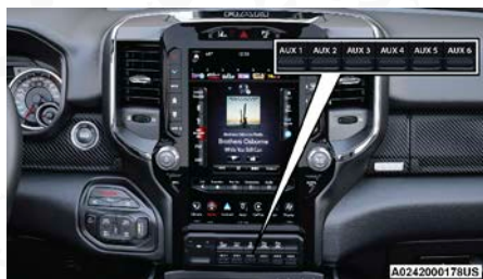
Ubicación de los interruptores auxiliares
