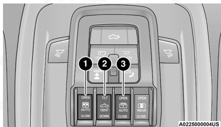
Interruptor del toldo solar
