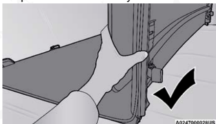
Doblado correcto - Mantenga los paneles juntos
