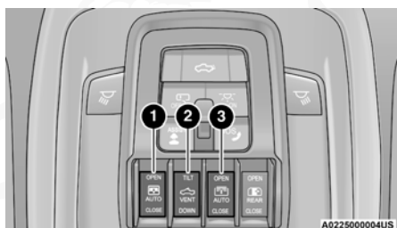
Interruptor del toldo solar
