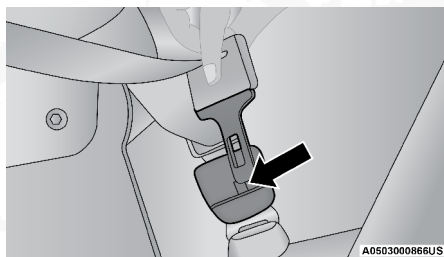
Desprendimiento de la hebilla con la lengua del cinturón de seguridad
