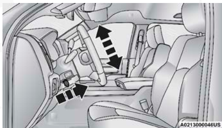
Palanca de la columna de dirección abatible
