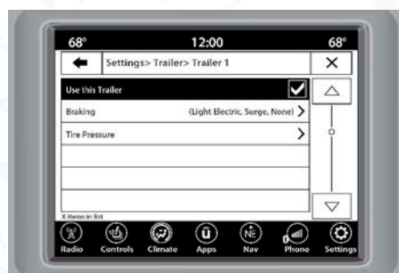
Ajustes del sistema de monitoreo de presión de llanta de remolque
