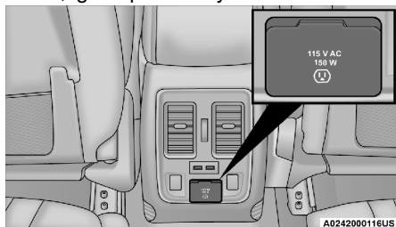
Inversor de corriente
