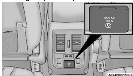
Inversor de corriente
