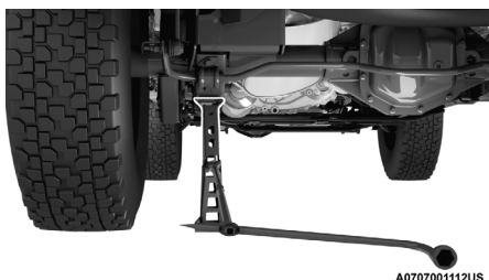
Colocación del gato en la parte trasera
