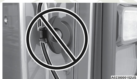
Cable de la compuerta trasera asentado incorrectamente
