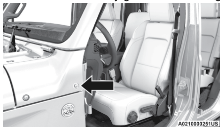
Ubicación del perno de la cubierta
