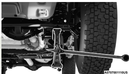
Colocación del gato en la parte delantera
