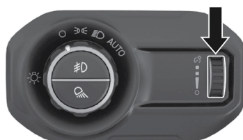
Control de atenuación
