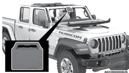
Cubierta protectora instalada
