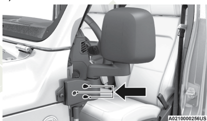
Ubicaciones de los tornillos de espejo
