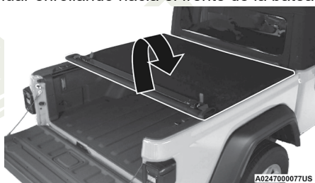
Enrollado de la cubierta hacia el frente
