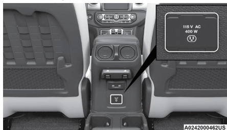
Inversor de corriente
