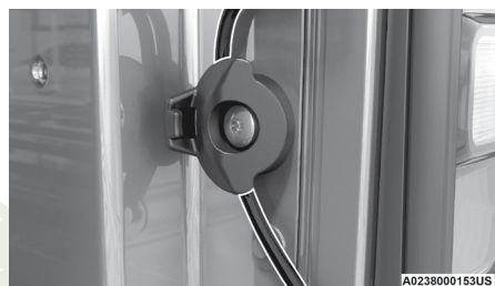
Cable de la compuerta trasera correctamente asentado
