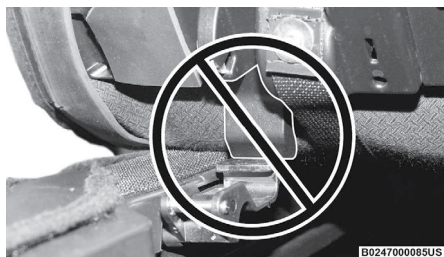
Fijador asentado incorrectamente
