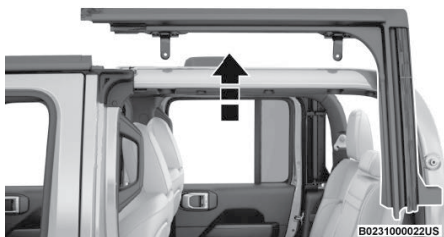
Dirección del movimiento-desinstalación
