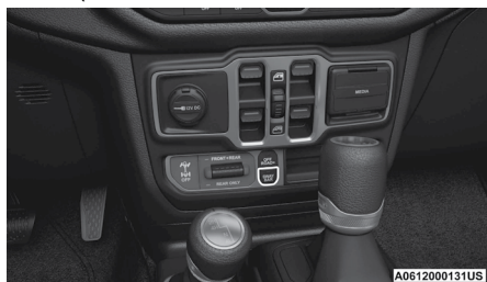
Interruptor de la barra estabilizadora
