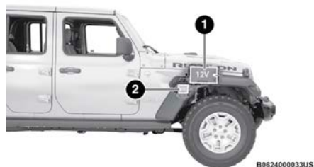
Ubicación de las baterías
