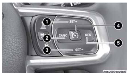
Botones del control electrónico de velocidad
