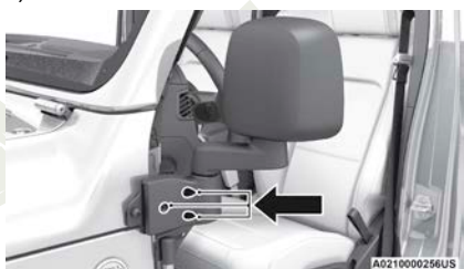
Ubicaciones de los tornillos de espejo
