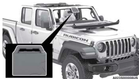
Cubierta protectora instalada
