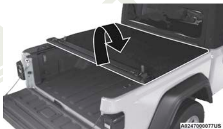
Enrollado de la cubierta hacia el frente
