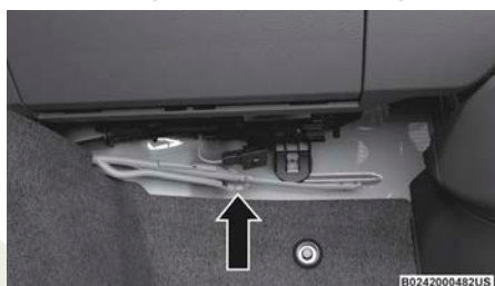
Conexiones de los interruptores auxiliares - Panel lateral del piso del pasajero delantero
