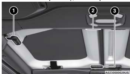
Giro de de los tres seguros del panel lado izquierdo
