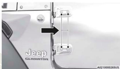
Ubicaciones de los tornillos de bisagra
