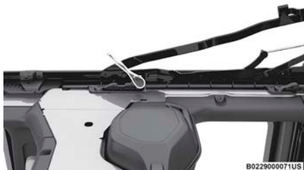
Desatornillar los sujetadores del mecanismo
