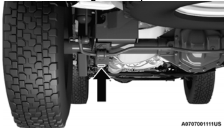
Punto de levantamiento en la parte trasera
