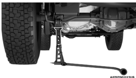
Colocación del gato en la parte trasera
