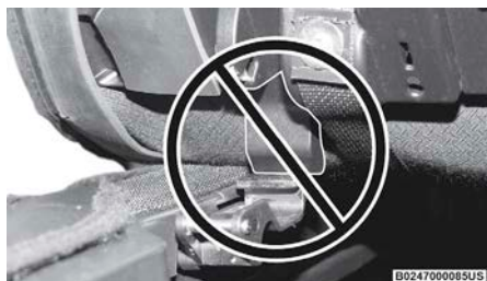
Fijador asentado incorrectamente
