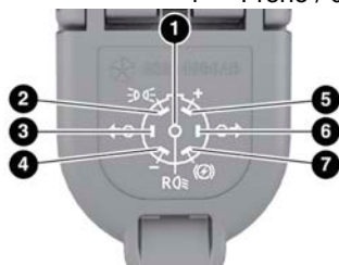
Conector de 7 terminales
