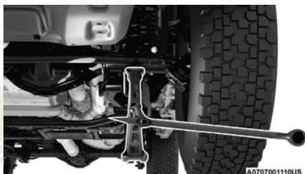
Colocación del gato en la parte delantera
