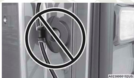
Cable de la compuerta trasera asentado incorrectamente
