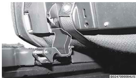
Fijador correctamente asentado
