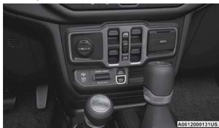
Interruptor de la barra estabilizadora
