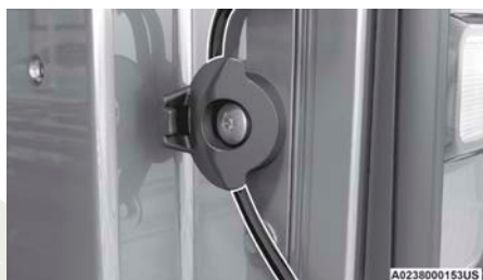
Cable de la compuerta trasera correctamente asentado
