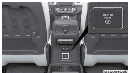
Inversor de corriente
