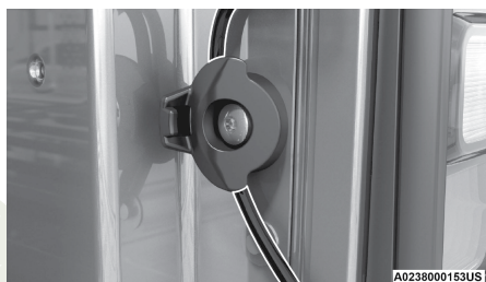
Cable de la compuerta trasera correctamente asentado
