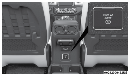
Inversor de corriente
