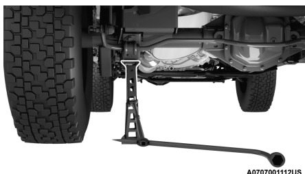
Colocación del gato en la parte trasera
