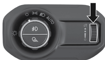
Control de atenuación
