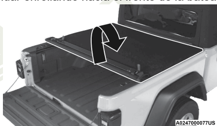
Enrollado de la cubierta hacia el frente
