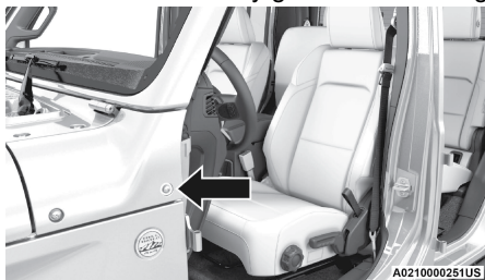
Ubicación del perno de la cubierta
