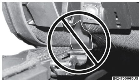
Fijador asentado incorrectamente
