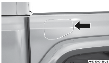
Compuerta del tapón de combustible
