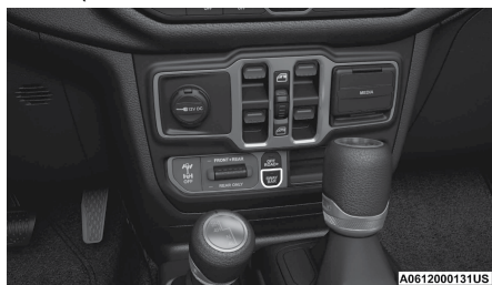
Interruptor de la barra estabilizadora
