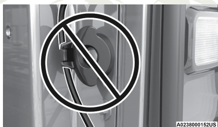
Cable de la compuerta trasera asentado incorrectamente
