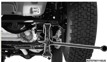
Colocación del gato en la parte delantera
