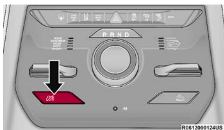
Interruptor de la caja de transferencia
