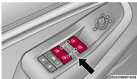
Interruptores de las ventanas eléctricas en la puerta del conductor
