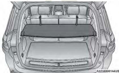
Cubierta del área de carga
