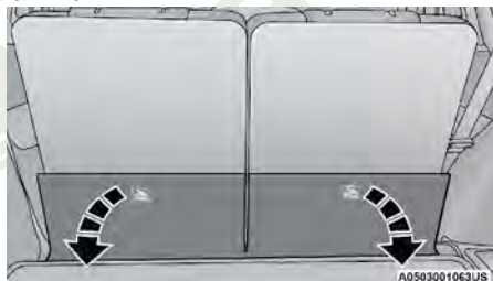
Desmonte de la cubierta alfombrada del respaldo para acceder a la correa superior (tercera fila de asientos)
