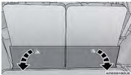
Desmonte de la cubierta alfombrada del respaldo para acceder al anclaje de correa superior (3ra fila de asientos)
