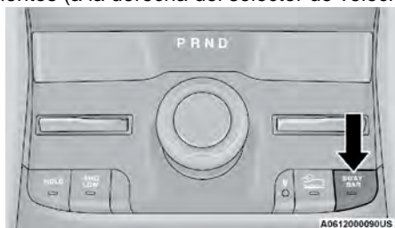
Interruptor de la barra estabilizadora
