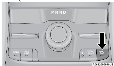
Interruptor de la barra estabilizadora
