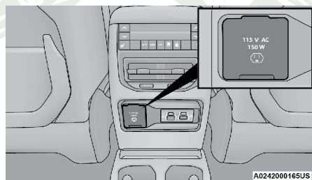
Inversor de corriente
