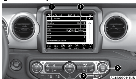
Botones en pantalla y tablero del sistema Uconnect® 4C/4C NAV
