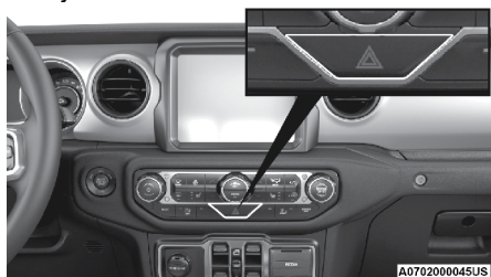
Interruptor de las luces de emergencia
