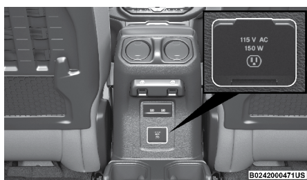
Inversor de corriente
